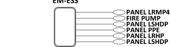
MAIN POWER METER (EM-ESS)
